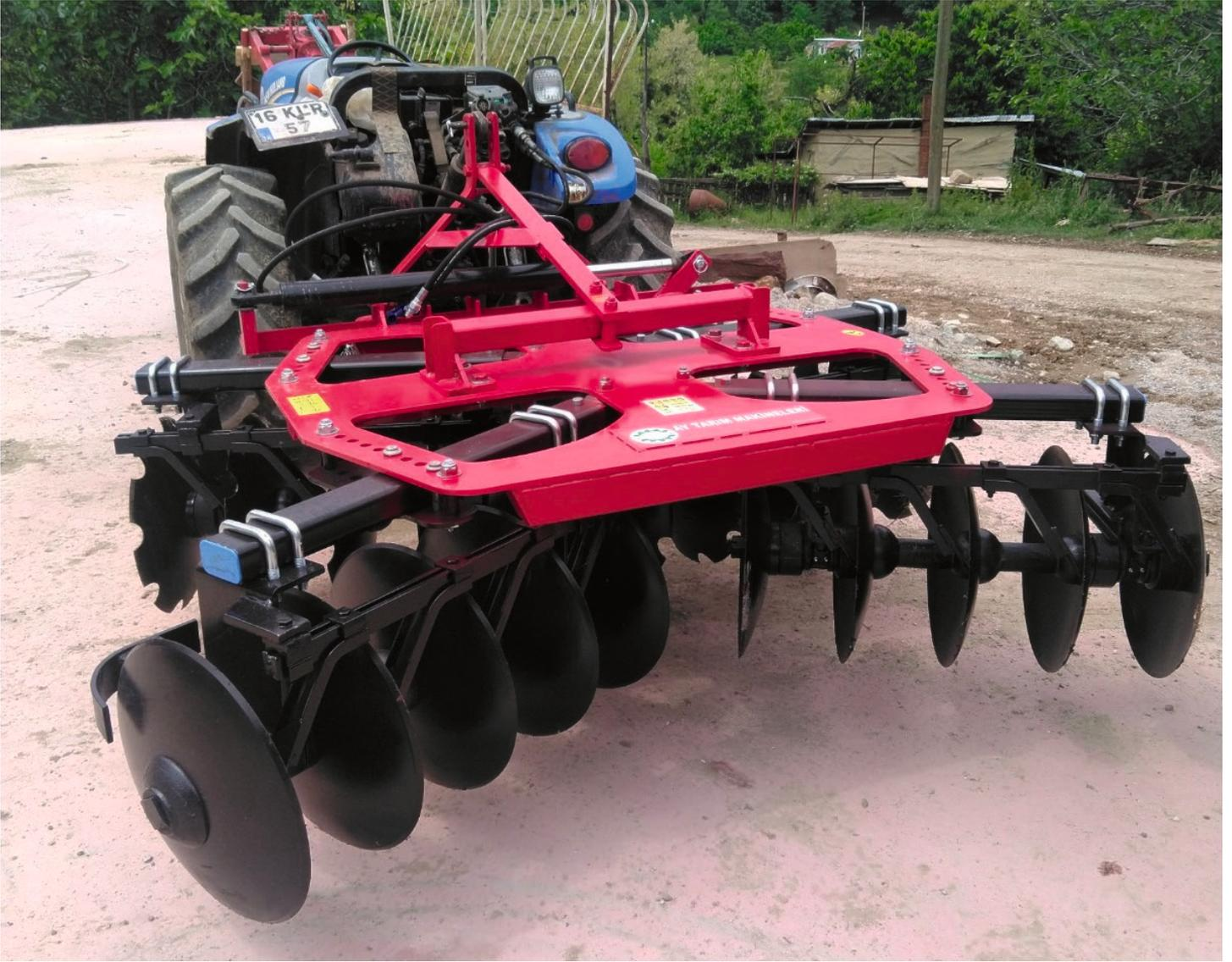
14-16-18-20-24- Disc optional hydraulic shifting optional 650 kg. - 800 kg. - 1000 kg. weight
